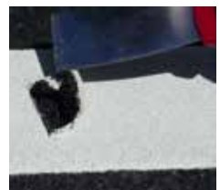
Fig. 4 Realice una prueba de cincel para verificar la adhesión. La evidencia, de asfalto adherido a la parte inferior del material levantado indicará una buena adherencia.
